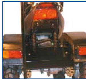
Forstærkningssæt består af en ekstra fjeder. Forstærkningssættet anbefales til brugere over 90 kg
