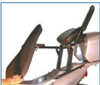
Rygstøtten vises opklappet for at skabe adgang til opbevaringsboksen under sædet
